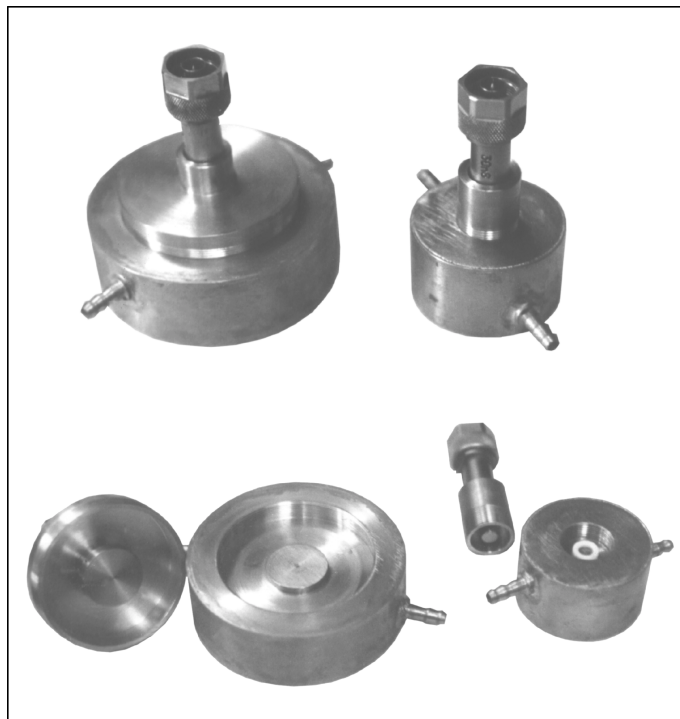
Рис. 2.7. Измерительные ячейки для установки ВДС
